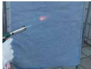
ファルガードをスプレー後乾燥し1400°Cのバーナーの火を綿布に直接当てています。
