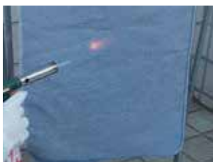
ファルガードをスプレー後乾燥し1400°Cのバーナーの火を綿布に直接当てています。
